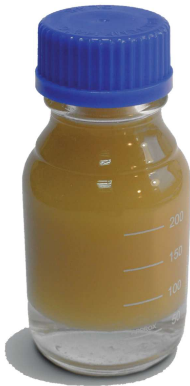
Obr. 4 Pred filtráciou 1,5 % (15 000ppm) H 2 O (zdroj: ECOFIL®)
