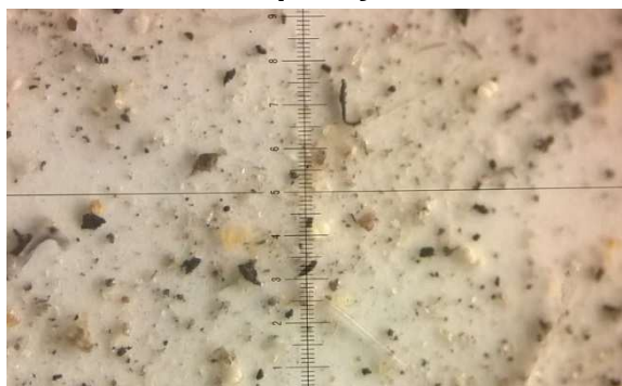
Obr. 2 Pred filtráciou, NAS1638 č.12 ISO 4406 č. 23/21/18
