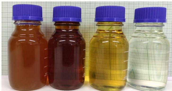
Obr. 9 Pred filtráciou Po filtrácii Po regenerácii (zdroj: ECOFIL®)
