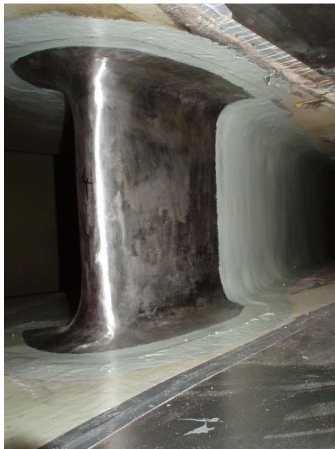
Obr.2 Předrozděcí lopata po opravě
